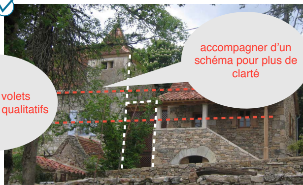
Extension respectueuse de l'existant et réinterprétant les codes de l'architecture traditionnelle / alignement des lignes fortes et des ouvertures en façade (lignes en orange et blanc) © phBa Architectes
