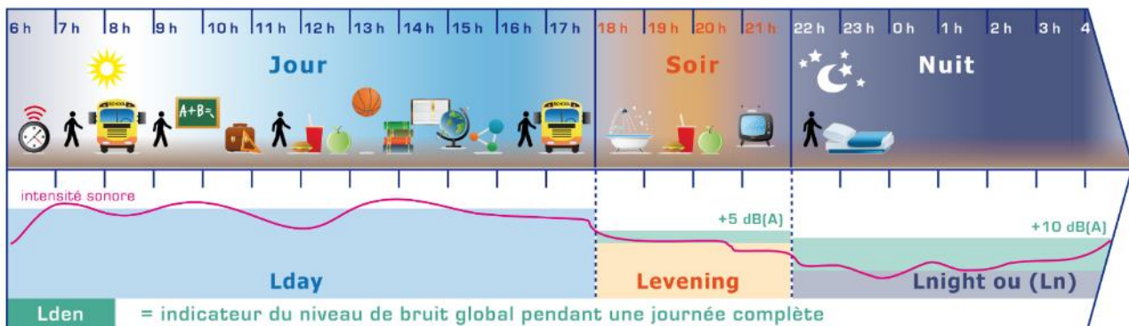
Figure 4 - Échelle des indicateurs acoustiques
